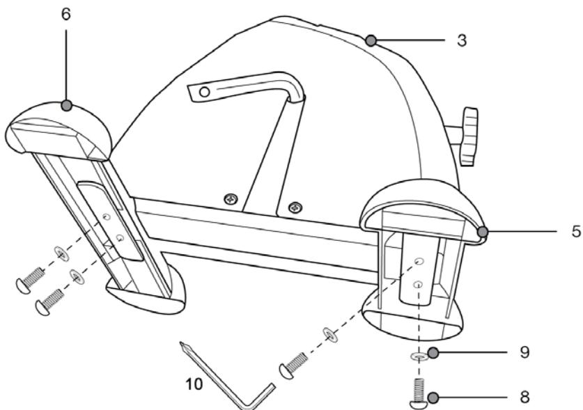
1. Прикрепите переднюю (5) и заднюю (6) опорные ножки к корпусу (3) тренажёра с помощью винтов (8) и шайб (9). Затяните крепёж, используя отвёртку (10).
