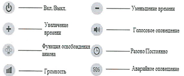
Рис.7. Схема пульта дистанционного управления
